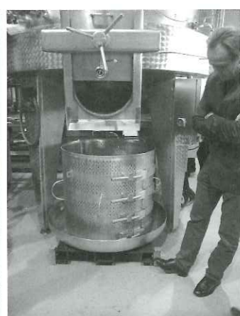
エスターハーギーの近代設備。赤ワインの醸し発酵を終えたらタンク底の部分はバスケットプレス器に直接受け、プレス果汁を得る。
